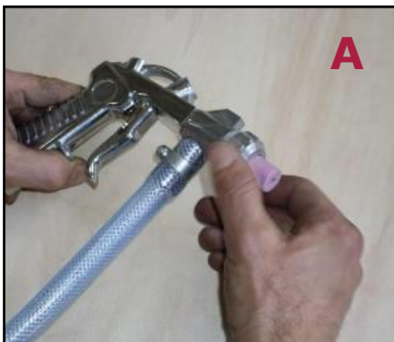
Фигура16 - Демонтаж на дюзата на пясъкоструйния пистолет.
