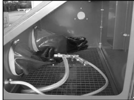
Фигура7 - Свързване на пистолета.
