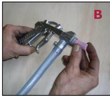
Фигура16 - Демонтаж на дюзата на пясъкоструйния пистолет.
